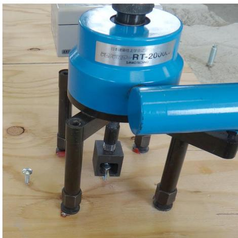
写真3 引抜き試験体
