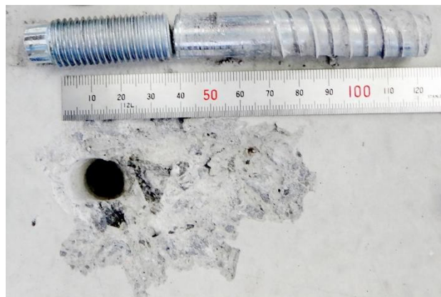
図12:破壊形態例 アンカー破断
