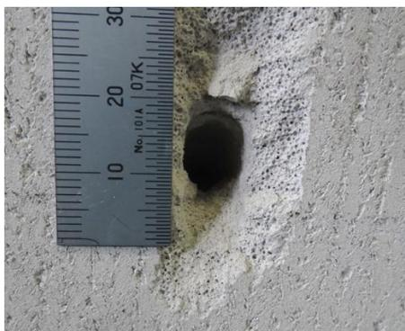
図4 ALC穴支圧破壊状況
