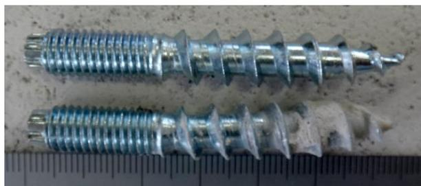
図5 試験後試料曲がり状況(上:試験前、下:試験後)
