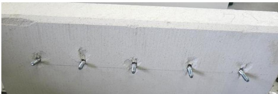
図3 試験後試料状況(載荷方向:上向き)
