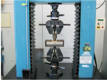
図 1 0 . 構造用合板の試験方法
