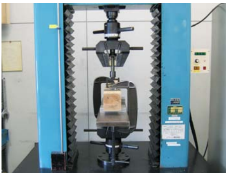
図 6. 杉角材の試験方法
