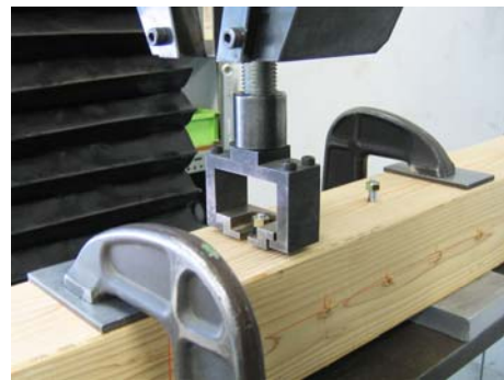
図 7. 杉角材の試験詳細
