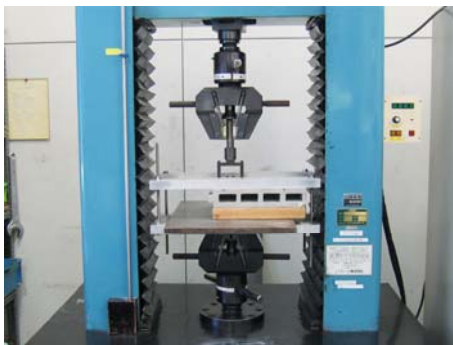
図 1 4 . 押出成形セメント板の試験方法
