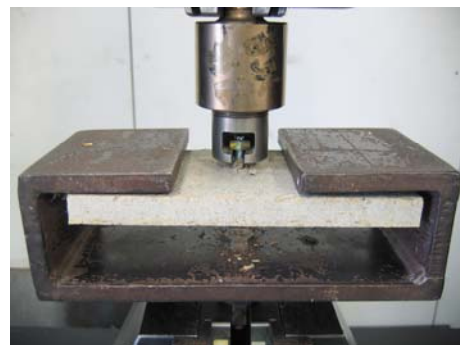
図 9. 耐火野地板の試験詳細
