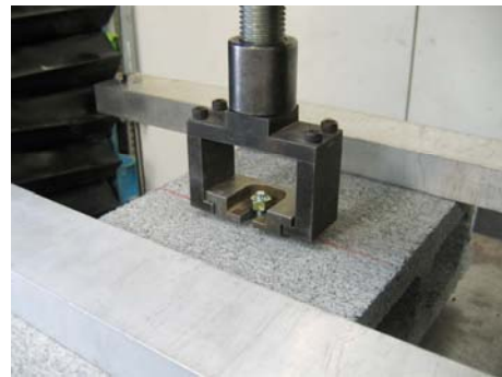
図 1 3 . 軽量・重量ブロックの試験詳細
