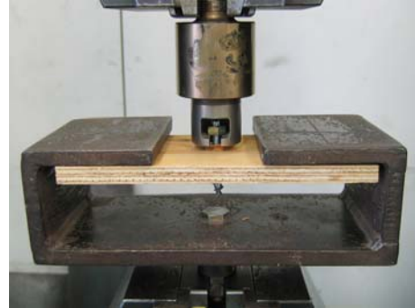
図 1 1 . 構造用合板の試験詳細
