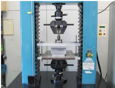
図 1 2 . 軽量・重量ブロックの試験方法
