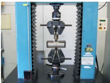
図 8. 耐火野地板の試験方法
