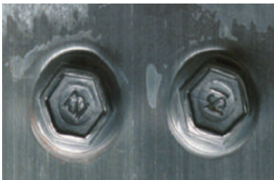
▲アルミ板との電食促進試験SST240時間
